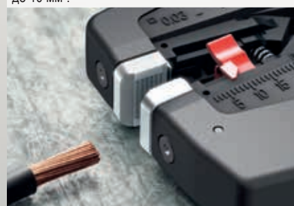
Автоматическая зачистка для сечений до 10 мм 2 .
