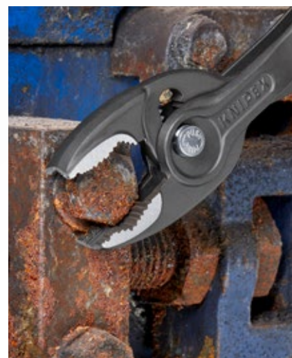
Коробчатый шарнир - прочный и гибкий, поэтому клещи могут удерживать детали в диапазоне от 4 до 22 мм.
